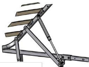
Możliwa regulacja siły poprzez dobór miejsca montażu sprężyn gazowych
